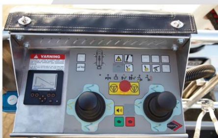
FPC: Proporcionálne CANbus ovládanie s displejom
