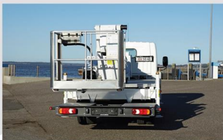
Zadná nástupná plošina (asymetricky uložený kôš)
