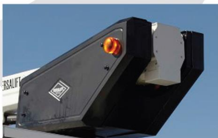
Zábleskové svetlá na stĺpe plošiny
