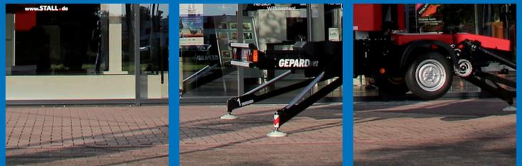
Der GEPARD 13 GT ermöglicht einen flexiblen Transport mit dem PKW. Für sicheres Arbeiten auf allen Untergründen sorgt die vollautomatische Abstützung und das Teupen-Bühnendesign „Made in Germany“.
