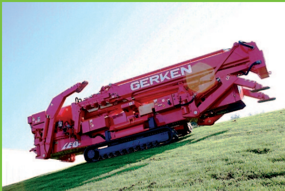
Stúpanosť 30% a výškovo a na šírku nastaviteľný pásový podvozok
