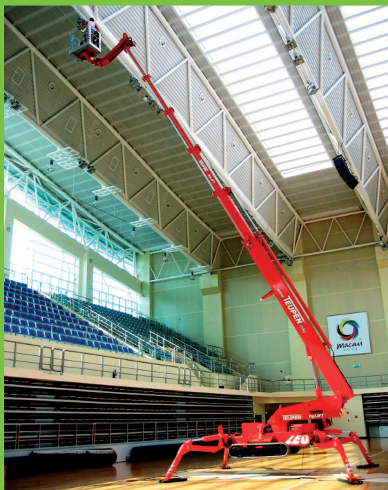
Bezpečne sa pohybuje a pracuje aj na chýlostivých povrchoch – palubovka športovej haly
