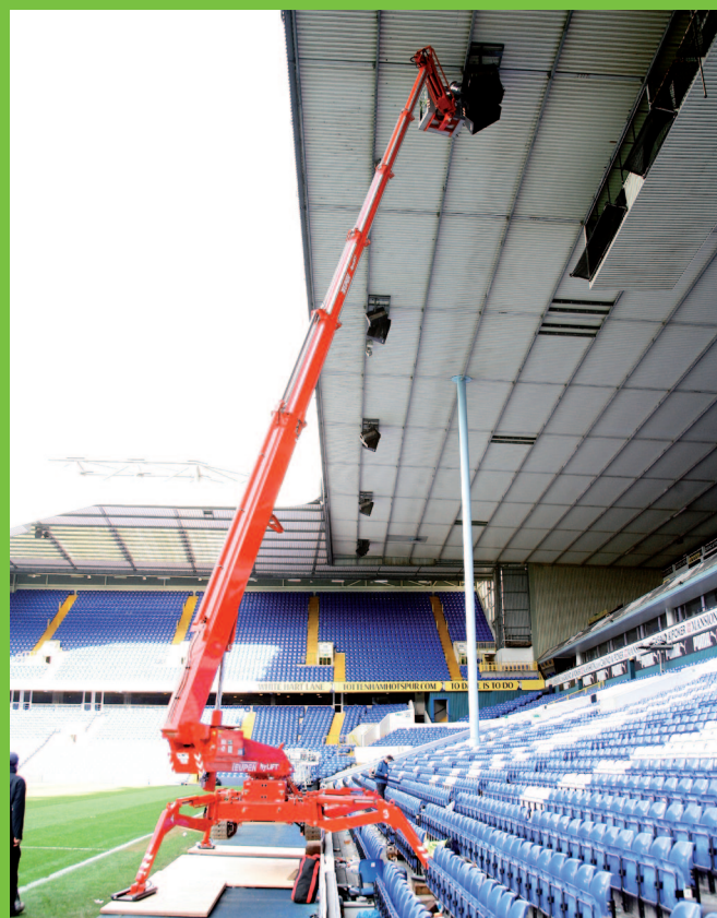
Variabilné podpery - široké alebo úzke podopretie plošiny v závislosti od voľného miesta
