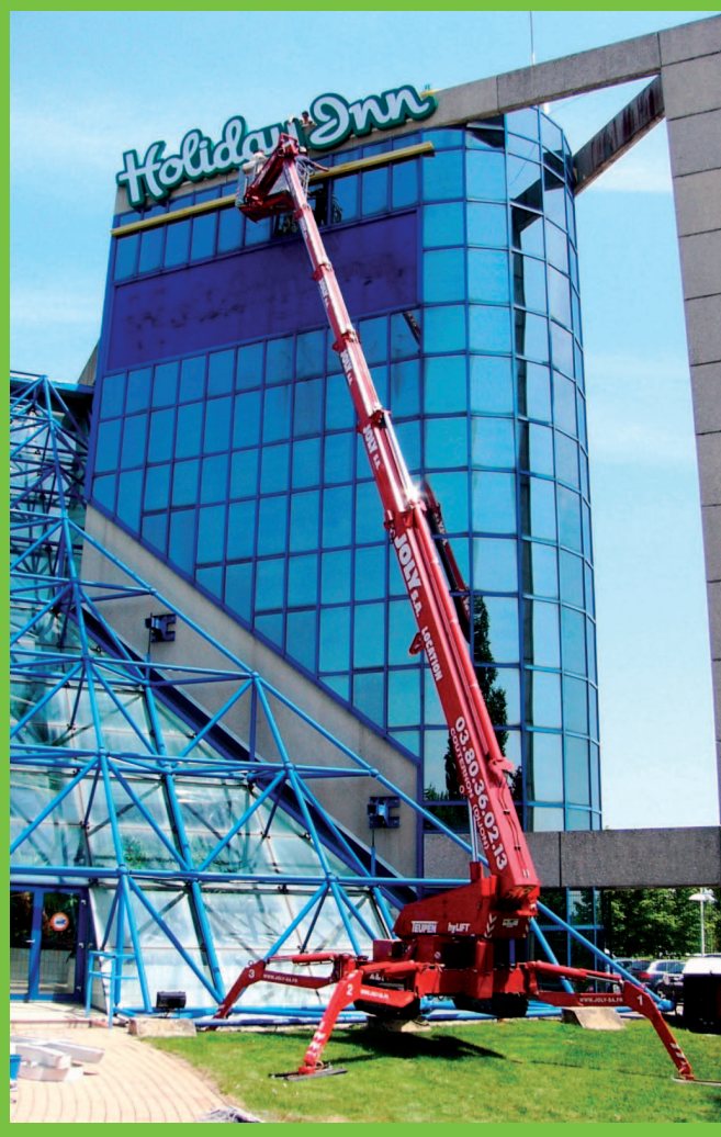
Variabilné podpery - široké alebo úzke podopretie plošiny v závislosti od voľného miesta
