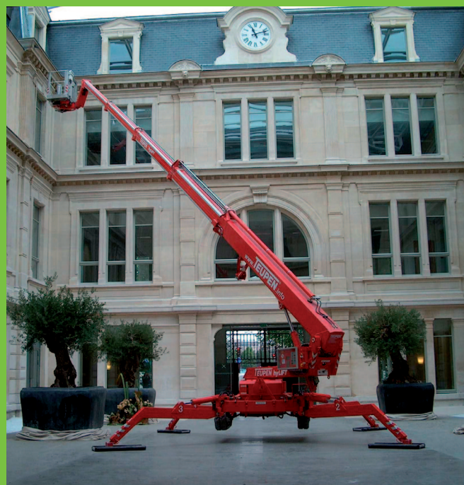
Variabilné podpory - široké alebo úzke podopretie plošiny v závislosti od voľného miesta
