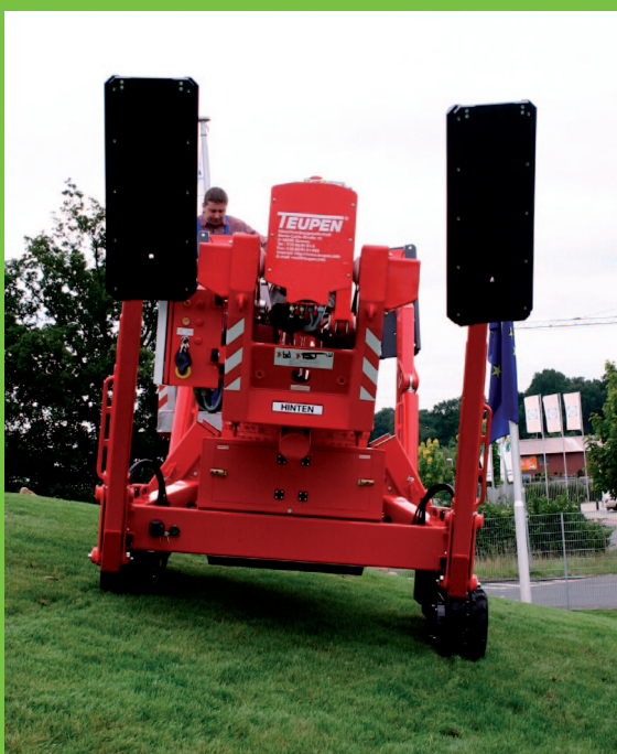
Patentovaný systém výškovo a na šírku nastaviteľného pásového podvozku
