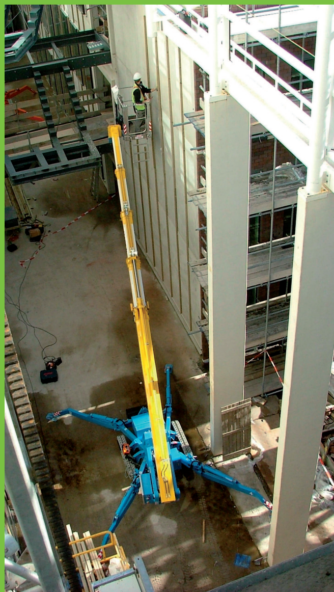
Variabilné podpory - široké alebo úzke podopretie plošiny v závislosti od voľného miesta
