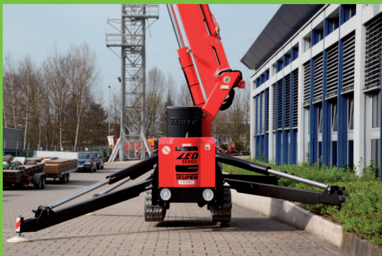
Rýchle a bezpečné postavenie do pracovnej polohy - s automatickým stabilizovaním plošiny prostredníctvom podpier
