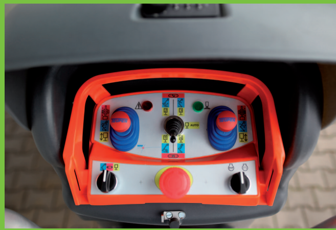
Prehľadný ovládač panel s komfortným ovládaním umožňuje jednoduchú manipuláciu s plošinou
