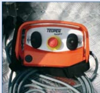
Kabelsteuerung für Reibradantrieb
