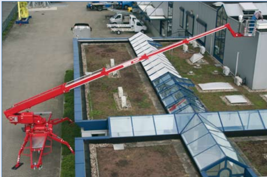
Bei einseitig schmaler Abstützung hat der GEPARD eine große seitliche Reichweite bei eingeschränktem Drehbereich
