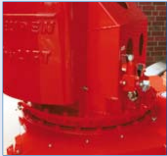
Grosser Drehkranz für optimale Lasteinleitung
